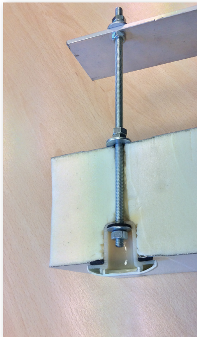
Uppskjutning av takpanelen direkt på den gängade staven i direkt anslutning till konstruktionen
